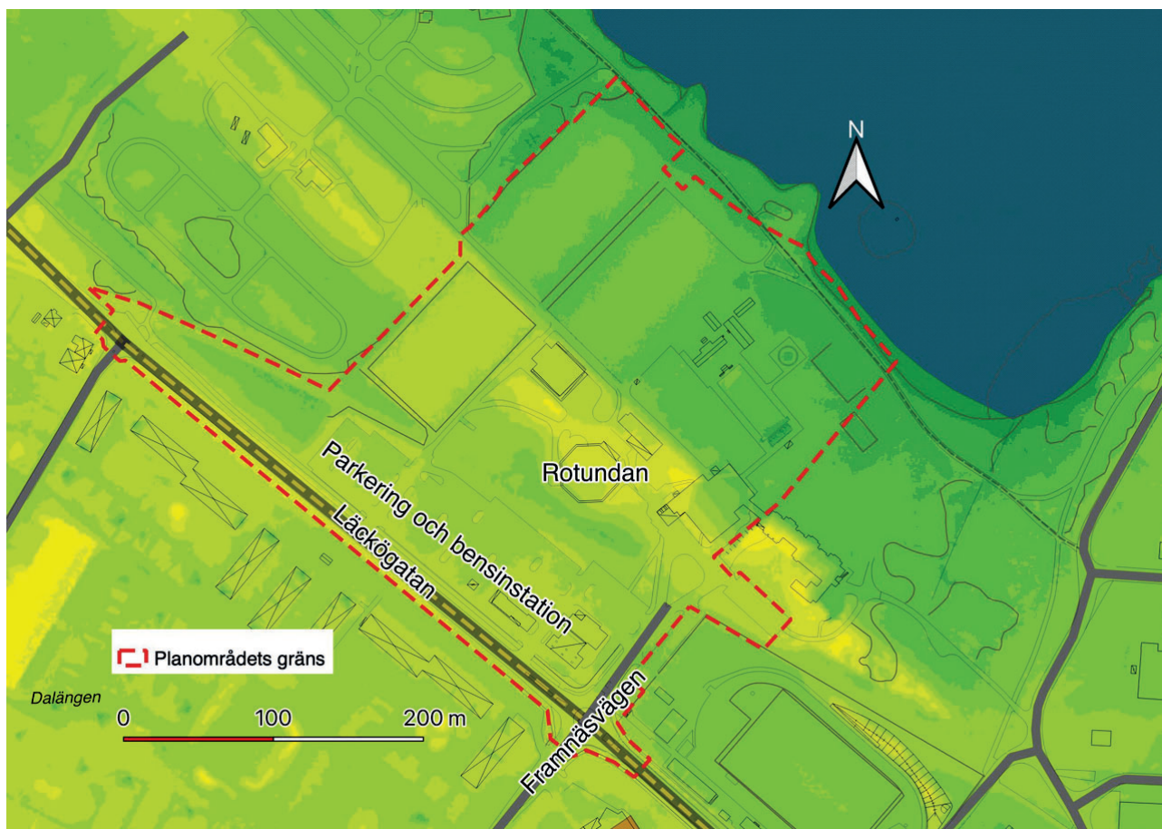
Figur 4: planområdets befintliga marknivå illustrerad med lägre mark i grönt och högre i gult. Varje färgnyans motsvarar ett intervall på 50 cm.
