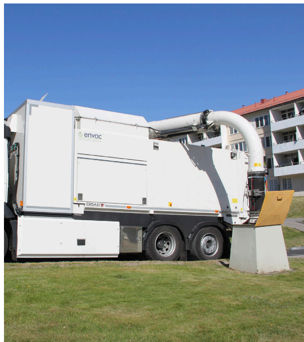
Mobil sopsug kopplad till en upphöjd dockningspunkt.
