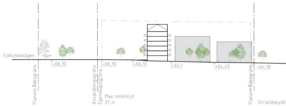
Figur 30 Principsektion A-A genom planområde och angränsande bebyggelse. Sektionen visar såväl maximal tillåten höjd (punktstreckad linje) samt det utbyggnadsförslag som planen baseras på. Skurna huskroppar redovisas med fet svart linje medan huskroppar framför snittet är gråtonade. Se figur 23 för sektionsmarkeringar. (Mareld Landskap, 2024)
