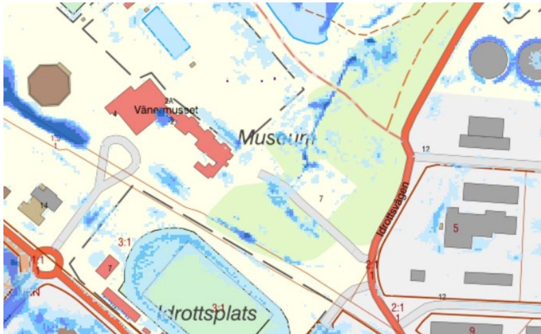
Figur 20 Klimatkomparerat (faktor 1,3) 100-års regn. Ljusblå ytor: 0,1-0,3 m stående vatten, besvärande framkomlighet. Mellanblå ytor: 0,3-0,5 m. Risk för stor skada, ingen möjlighet att ta sig fram med motorfordon. Mörkblå ytor: < 0,5 m. Risk för människors liv och hälsa.
