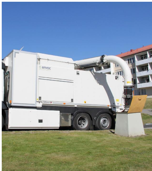
Mobil sopsug kopplad till en upphöjd dockningspunkt.
